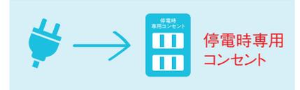
**4** 使用したい電気製品を「停電時専用コンセント」に接続して使用する。その際、使用電力が発電電力以下になるよう電気製品の使用量を調整する。
