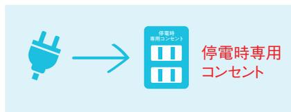
4 使用したい電気製品を「停電時専用コンセント」に接続して使用する。その際、使用電力が発電電力以下になるよう電気製品の使用量を調整する。
