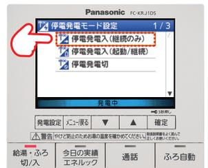
**4** カーソルが「停電発電入(継続のみ)」または「停電発電入(起動/継続)」になっていることを確認してください。※「切」になっている場合は、「▼」「▲」で「停電発電入」を選び、「確定」を押す。
