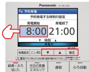
**3** 「▼」「▲」で発電の開始時刻を設定し、「確定」を押す。
