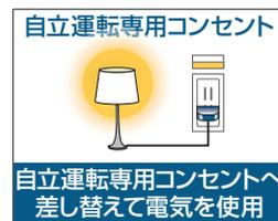
自立運転専用コンセントへ差し替えて電気を使用
