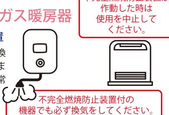
不完全燃焼防止装置付の機器でも必ず換気をしてください。
