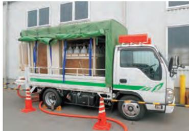
移動式ガス発生設備積載車
