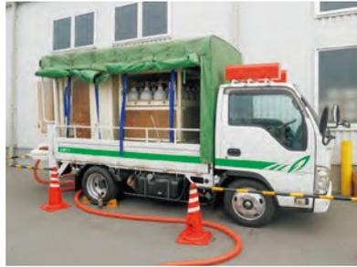
移動式ガス発生設備積載車
