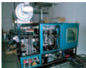
バイオガス専燃コージェネレーションシステムの開発(ロータリーエンジン)
