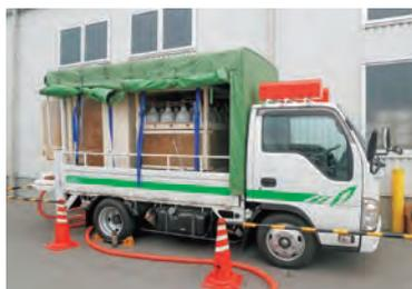
移動式ガス発生設備積載車
