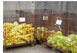
ガス導管には耐食性・可とう性に優れ地震にも強いポリエチレン管 (PE管) を1989年から採用しています。また、不要になったPE管は100%再資源化しています。
