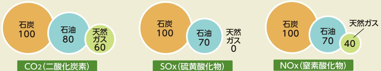
天然ガスは、石油や石炭に比べ、燃焼時に排出されるCO<sub>2</sub>や有害物質の量が少ないため、化石燃料の中でもクリーンなエネルギーといわれています。
