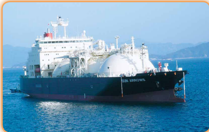
▲液化天然ガス専用のタンカー (LNG タンカー) 大きなタンクに液化天然ガスを入れて運んできます。
