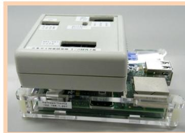
初期モデルで、Raspberry Piの上に乗せる形で製作した。WANとの通信機能は持っておらず、外部に3Gルータを設置し、そのルータに挿したUSB3G通信 dongleでインターネットに接続していた。
