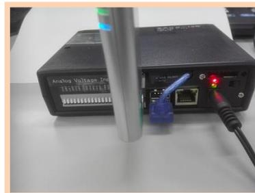
外観写真は「アナログログナー」Ver2.3のもの。このバージョンから3Gルータが不要となった。同時に、パルス計測用に「パルスログナー」、アナログ・パルス・熱源対計測を行う「総合ログナー」を製作している。
