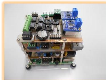
このモデルは、Raspberry Piの上に3段重ねる基板構造としたが、製作、取扱いともに難しく、実験のみで終了。この時点で、アナログ計測、熱電津計測、パルス計測が可能となった。外部に3Gルータが必要なことは(1)と同じ。
