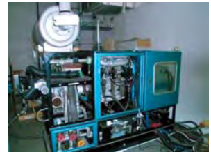
バイオガス専燃コージェネレーションシステムの開発 (ロータリーエンジン)
