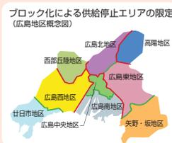
ブロック化による供給停止エリアの限定
