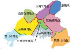
ブロック化による供給停止エリアの限定 (広島地区概念図)
